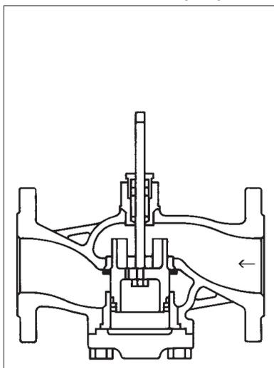
Řez tlakově vyváženým ventilem s děrovanou kuželkou
